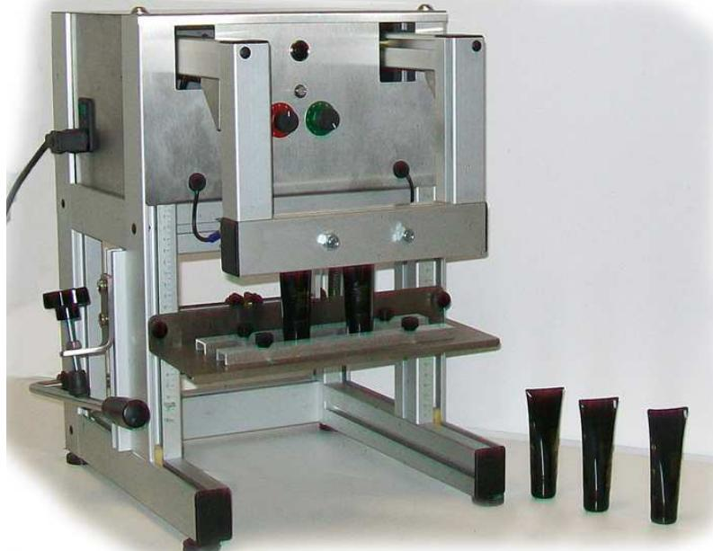
La saldatrice VTBmini è la versione compatta da banco del modello VTB/6/T, saldatrice per la chiusura di tubetti in plastica, con resistenza saldante da 6mm su entrambe le ganasce e forte pressione meccanica di schiacciamento.
