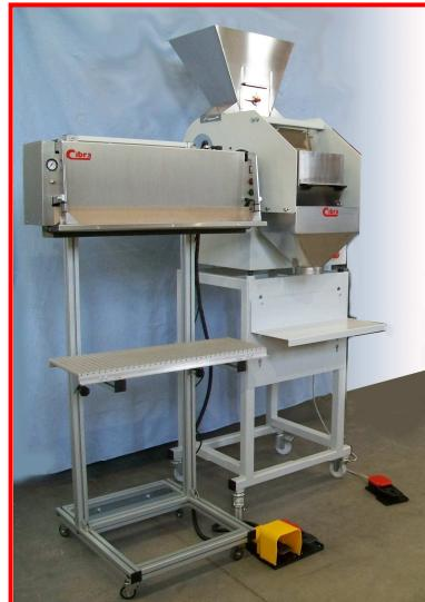
accostando alle saldatrici PN un dosatore (non fornito da Cibra) si crea una perfetta linea di imballaggio
