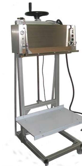
La saldatrice PN può essere appoggiata su un **tavolo** qualsiasi oppure può essere posta **verticalmente sull'apposito supporto** con volantino di regolazione altezza. Su richiesta può essere fornito con piano d'appoggio ad altezza regolabile, che può essere una mensola oppure un piano a rulli.
