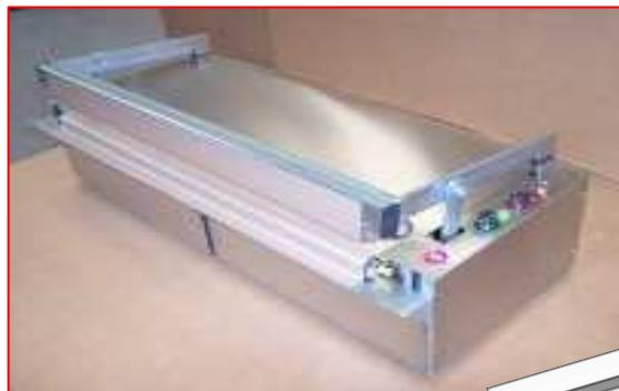
Premendo il pedale si dà inizio al **ciclo automatico** di chiusura ganasce - saldatura - raffreddamento - riapertura, i cui tempi vengono regolati sui temporizzatori secondo le necessità del materiale da saldare ed indicati da spie luminose.
