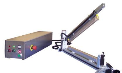
Tempo di saldatura e tempo di raffreddamento vengono impostati sui temporizzatori posti sull'alimentatore. Una volta serrata e bloccata la pinza con l'aggancio manuale, si avvia il ciclo col pulsante di start posto sulla pinza stessa.
