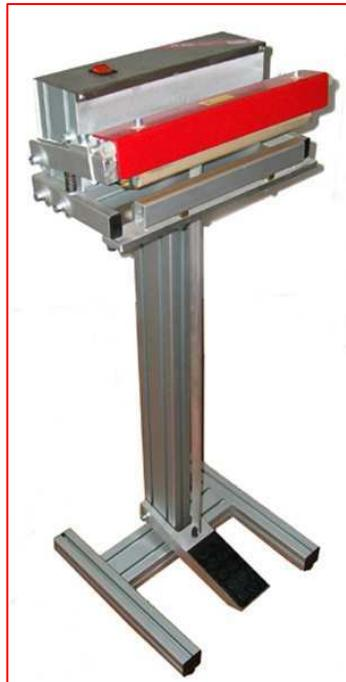
Saldatrice a pedale per saldare rapidamente ed ermeticamente sacchetti di polietilene, PVC e polipropilene di spessore massimo 60 micron, e di larghezza fino a cm 30. **L'impronta di saldatura è a binario**, 2 righe sottili parallele distanziate di 10 mm.
