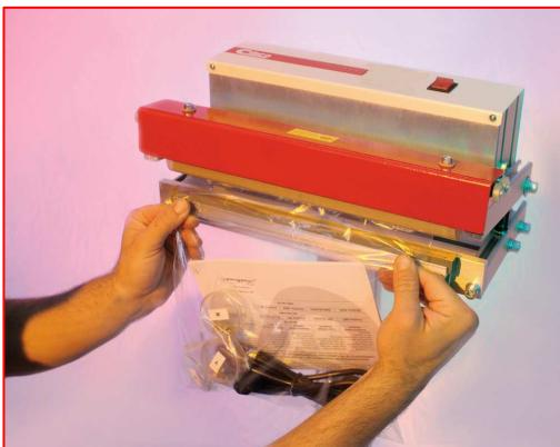
La saldatrice MN sigilla istantaneamente nel tempo di abbassare e rialzare il pedale sacchetti in polietilene, polietilene espanso, pluriboll e alcuni tipi di TNT. Per questi ultimi viene usata la versione MN 45 che è più potente. La saldatura recide l'eccedenza del sacchetto, che resta sigillato con una saldatura "a micronastro" sul filo del bordo.
