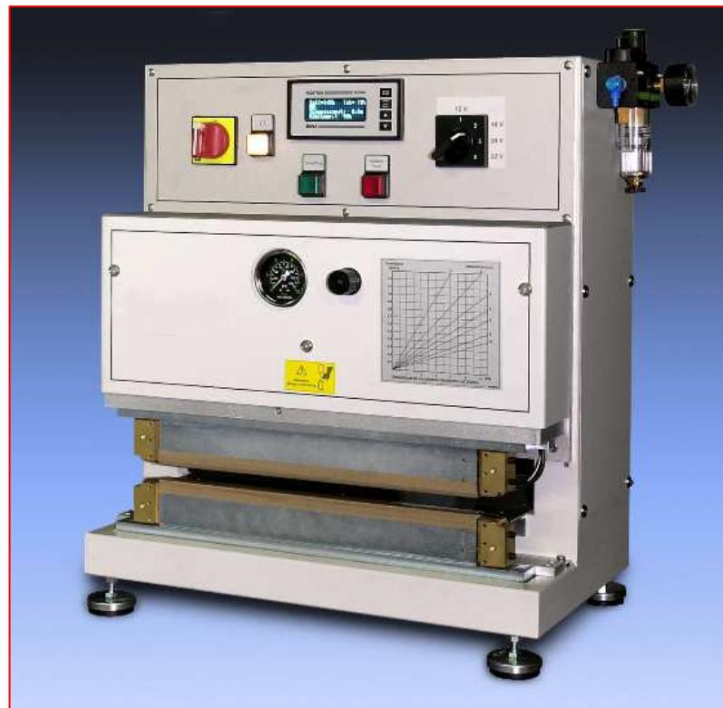
Tutti i parametri di saldatura possono essere regolati e ripetuti con precisione estrema dal microprocessore:
