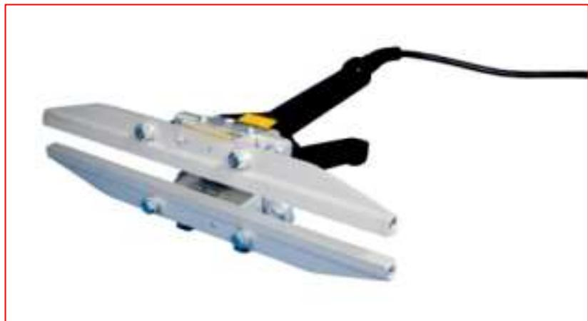
La pinza HWP esegue istantaneamente una saldatura larga 12 mm su una lunghezza di 40 cm, ripetibile per saldare lunghezze senza limite. L'impronta di saldatura è zigrinata orizzontalmente.
